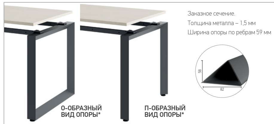
ОПОРЫ С ТРЕУГОЛЬНЫМ СЕЧЕНИЕМ
