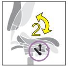
Топган – обеспечивает совместное качание спинки и сидения с фиксацией в двух положениях
