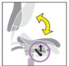
Мультиблок – обеспечивает совместное качание спинки и сидения с фиксацией в произвольном положении
