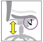
Газлифт – осуществляет регулировку сидения по высоте и обеспечивает амортизацию сидения
