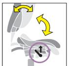
Синхромеханизм – обеспечивает качание спинки и сидения с синхронным изменением угла между ними в соотношении 1:3
